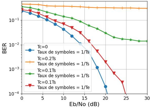
FIGURE 3. TEB du système FDSM en tenant compte du temps de réponse du commutateur ( $T_C$ )
