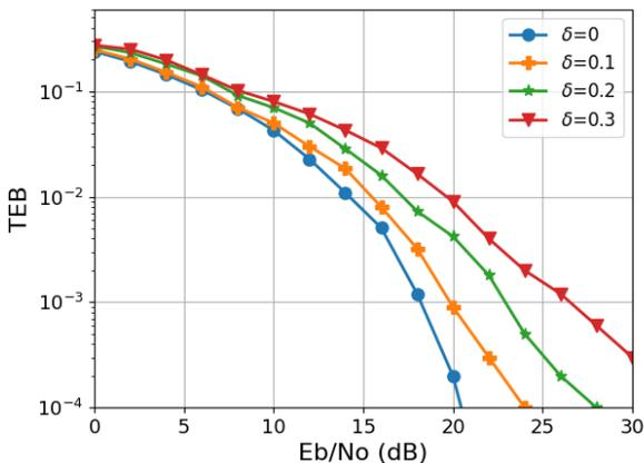
FIGURE 4. TEB du système FDSM pour différents écarts  $\delta$  entre les pertes d'insertion du commutateur
