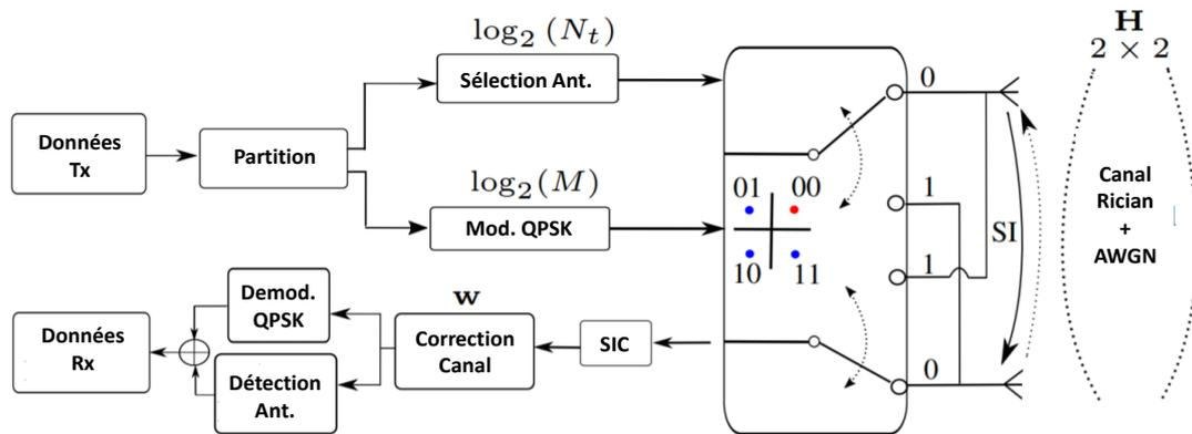
FIGURE 1. Schéma fonctionnel d'un système FDSM 2x2
