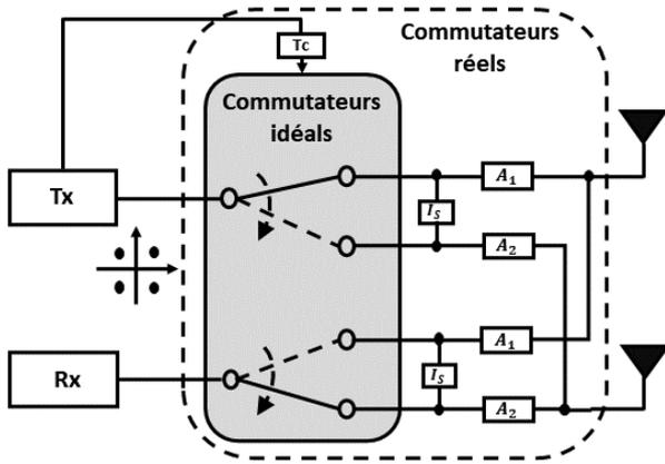
FIGURE 2. Commutateurs RF d'un système FDSM  $2 \times 2$
