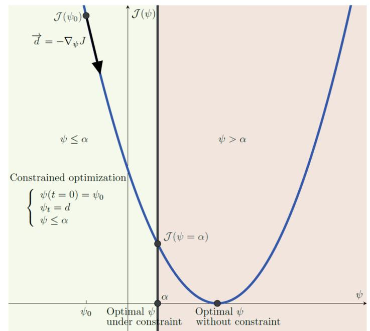
Fig. 2. Illustration de descente du gradient avec des contraintes de conservation sableuse et de pente représentés par  $\psi \leq \alpha$ . L'optimum ne correspond pas nécessairement au point critique.
