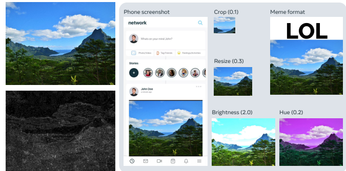
FIGURE 3 – Exemple d’une image ( 800 \times 600 ) tatouée à PSNR=40dB et FPR= 10^{-6} , et quelques altérations pour lesquelles le tatouage est détecté. L’image en noir et blanc montre l’amplitude du signal du tatouage.
