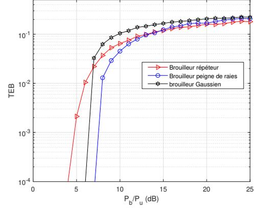
FIGURE 2 – TEB avec BPSK conventionnelle (1er scénario).
