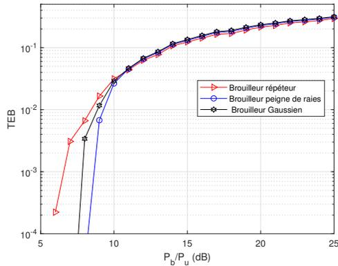
FIGURE 4 – TEB avec BPSK conventionnelle (2ème scénario).
