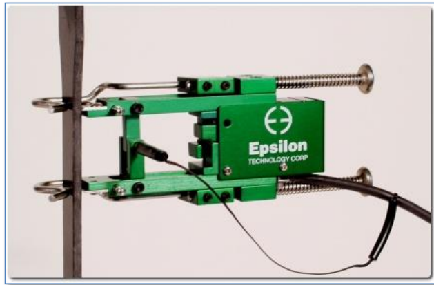
Instrumentation : extensomètre à couteaux [d'après http://www.epsilontech.com/ ]
