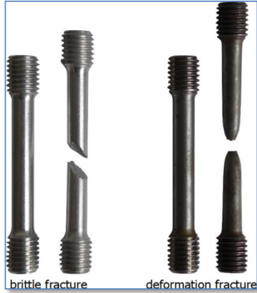
Rupture fragile et rupture ductile en traction
