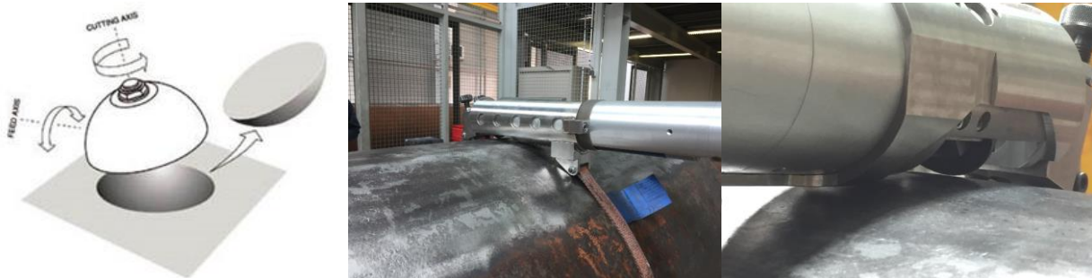
Figure 3 : Dispositif de prélèvement à l'emporte-pièce – Scoop sampling.
