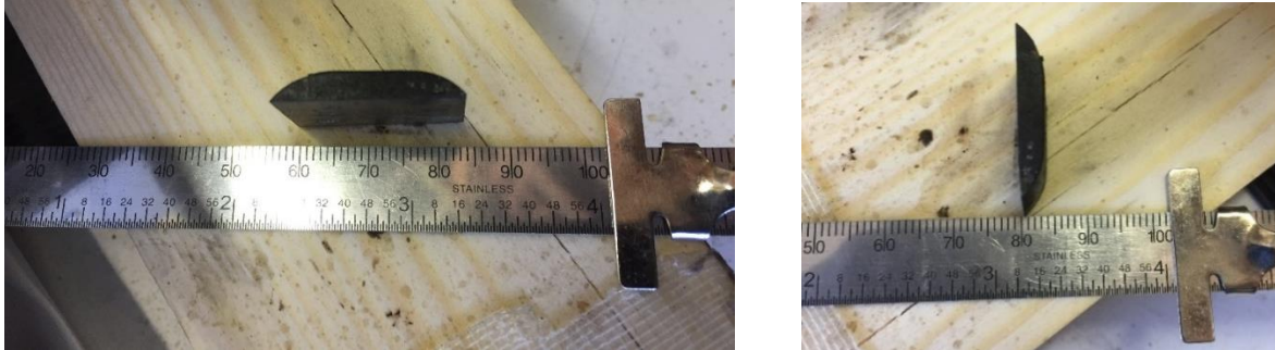
Figure 2 : Échantillon de type « boat sample » prélevé avec technique EDSE
