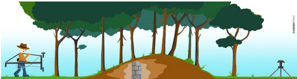
Fig. 4. Prospection magnétique en milieu forestier avec enregistrement synchronisé des mesures d'altitudes.
