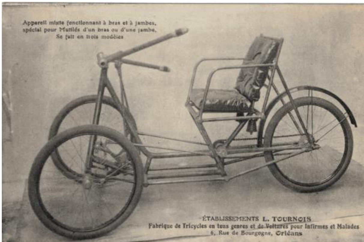
Figure 19 : Tricycle à entraînement mixte par les bras et les jambes. © Collection JP. Martin.
