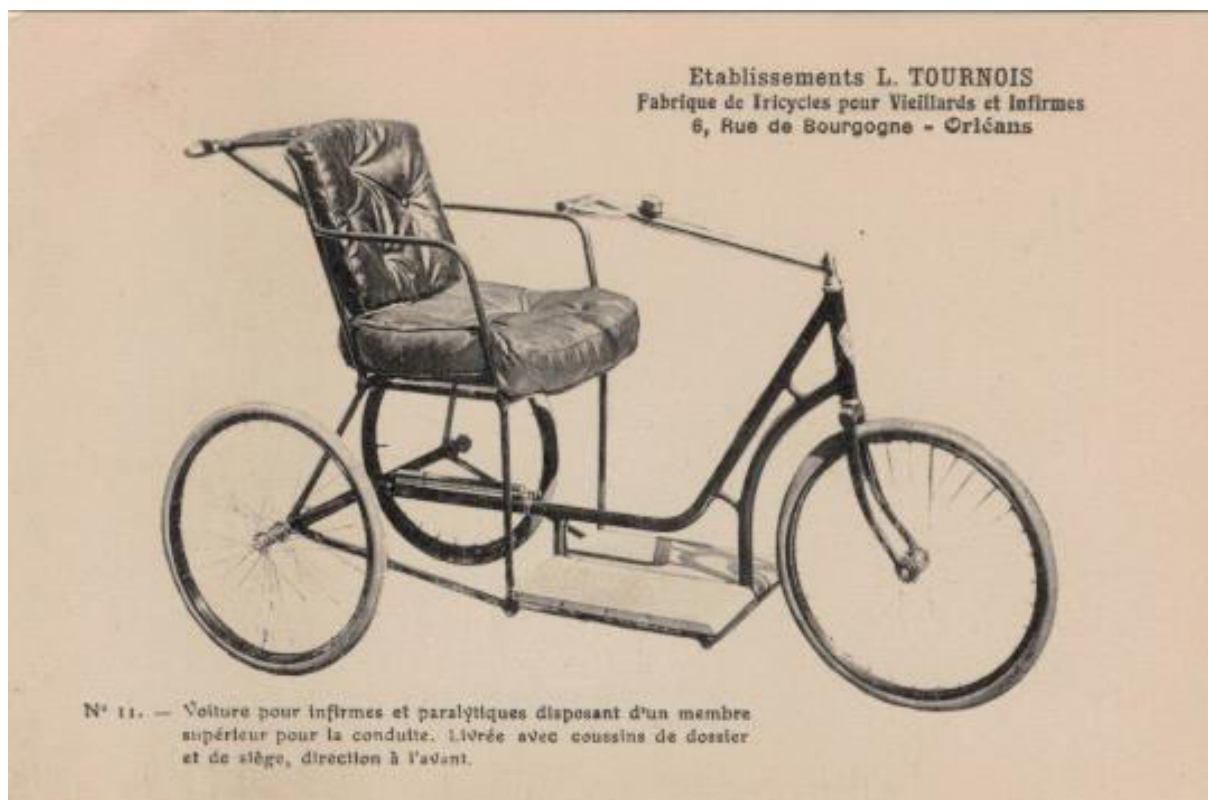
Figure 14 : Voiture pour infirmes et paralytiques disposant d'un membre supérieur pour la conduite. © Collection JP. Martin.
