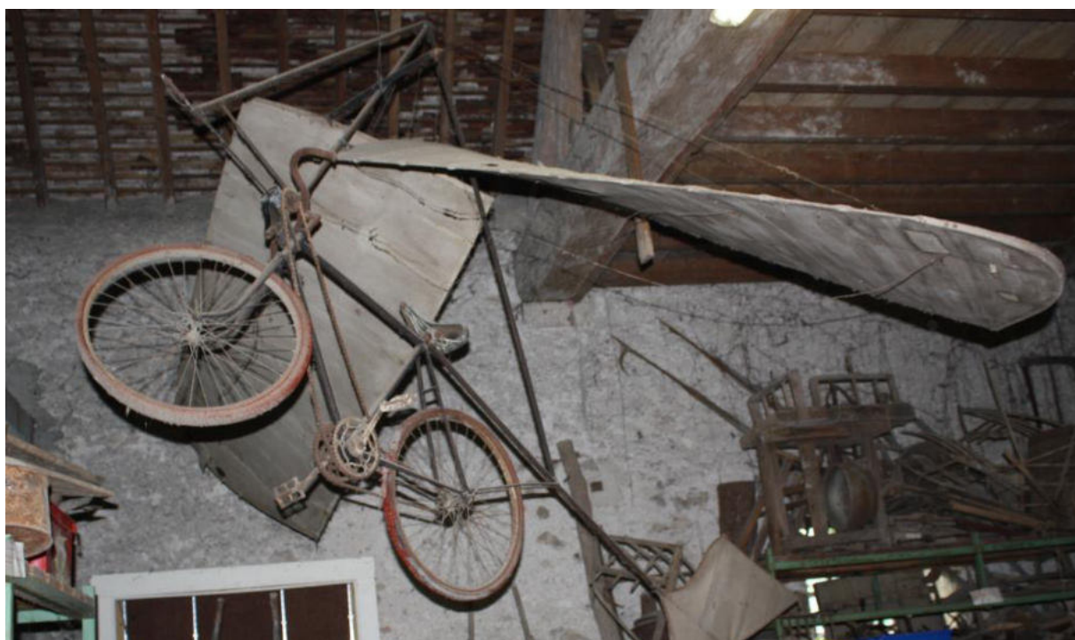
Figure 6 : Modèle d'aviette de Lucien Tournois conservé dans les réserves du musée de la Corbillière, à Mer. L'hélice est manquante. © Musée de la Corbillière, Mer (41).
