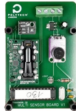
Figure 3 : Carte multicateurs développée à Polytech Angers.
