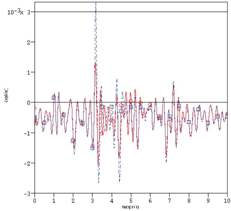
**Figure 3.** Evolutions comparées des déplacements sur le radier : (traits pleins) avec décollement, (traits tiretés) sans décollement
