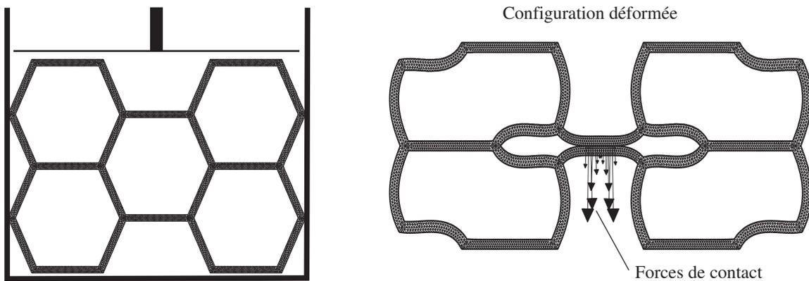
**Figure 6.** *Echantillon à 5 cellules comprimé avec flambement*
