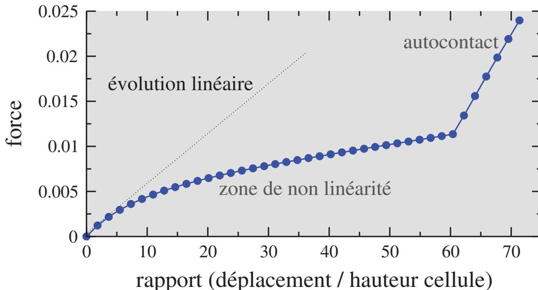
**Figure 5.** Courbe force de réaction - taux de compression
