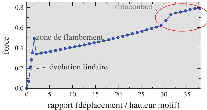
**Figure 10.** *Courbe force de réaction - taux de compression*
