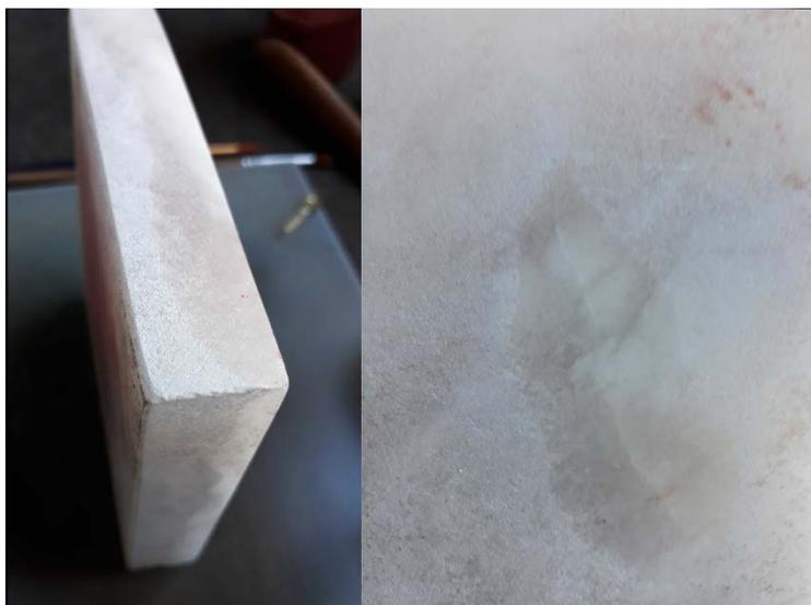
*Figure 7 : Diffusion de l'huile de lin autour des échantillons et à travers la fissure de la plaque 1*
