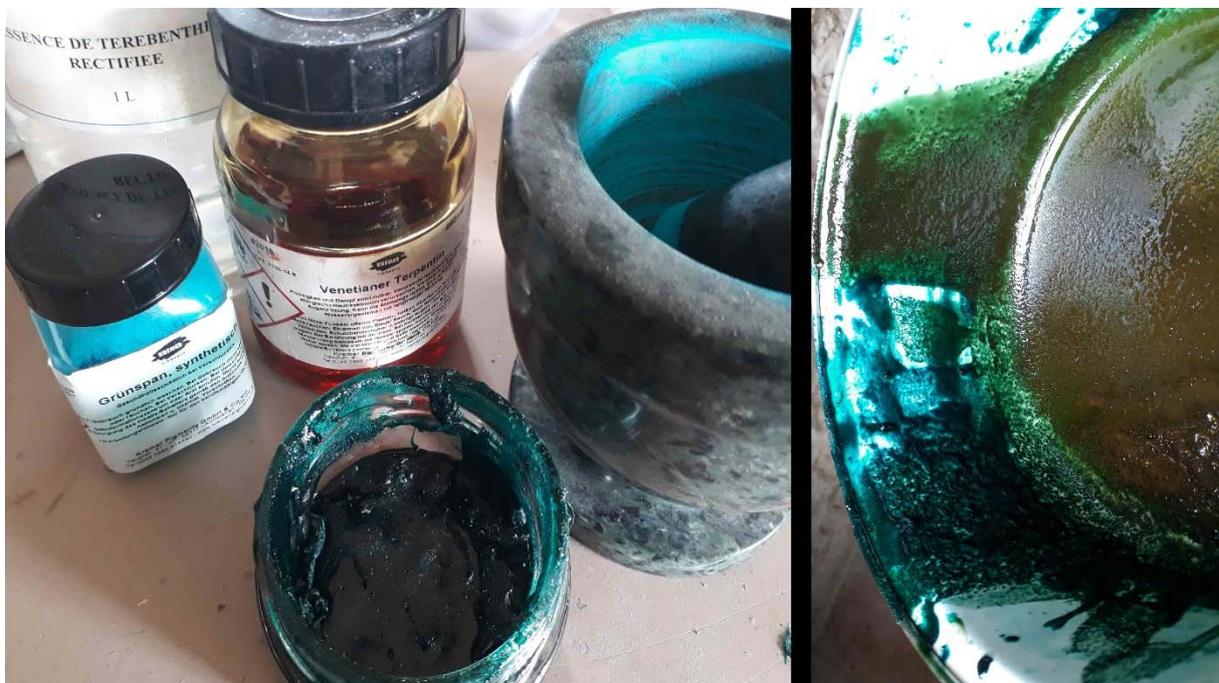
Figure 11 : Fabrication du résinate de cuivre : ingrédients ; variation des nuances sur les rebords du récipient correspondant aux différentes phases de chauffe.
