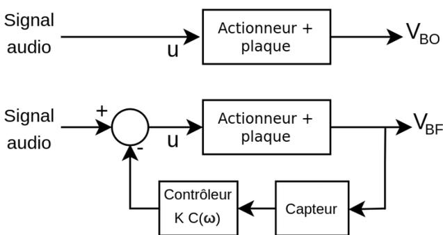
FIGURE 4 – Diagramme du contrôle vibratoire actif
