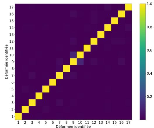
FIGURE 9 – Matrice de MAC des déformées identifiées
