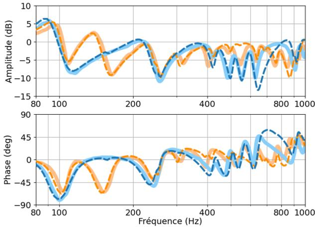
FIGURE 3 – Loi de contrôle  $\frac{V_{BF}}{V_{BO}}$  : actionneur centré (bleu) et excentré (orange), mesurées (–) et simulées (–)
