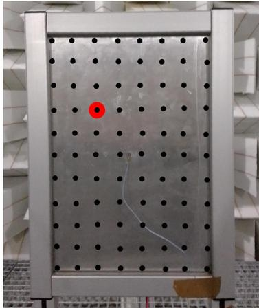
FIGURE 7 – Emplacements des mesures (noir) et de la position de l'actionneur (rouge) pour l'analyse modale
