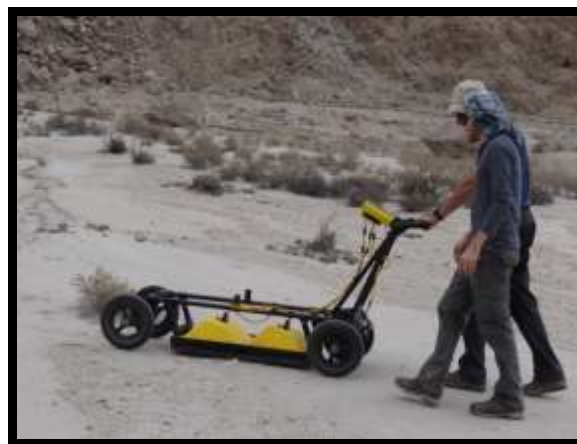
Fig. 24: prospection géophysique sur le site de Tirisha, radar à pénétration de sol. C. Camerlynck et Q. Devers. Clichés MAFIL.
