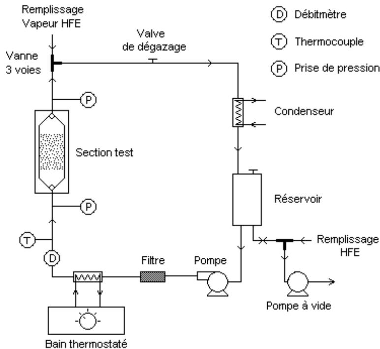
Figure 2 Dispositif expérimental : la boucle fluide.
