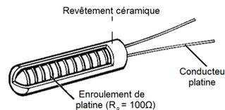
Figure 4 Élément sensible d'une sonde RTD (Pt 100).
