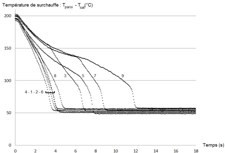
Figure 7 *Evolution de la température des cylindres surchauffés au cours du renoyage.*
