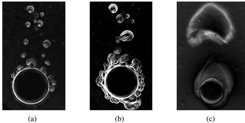
Figure 6 (a) *Ebullition nucléée partielle* ;(b) *Ebullition nucléée intense* ;(c) *Ebullition en film*.
