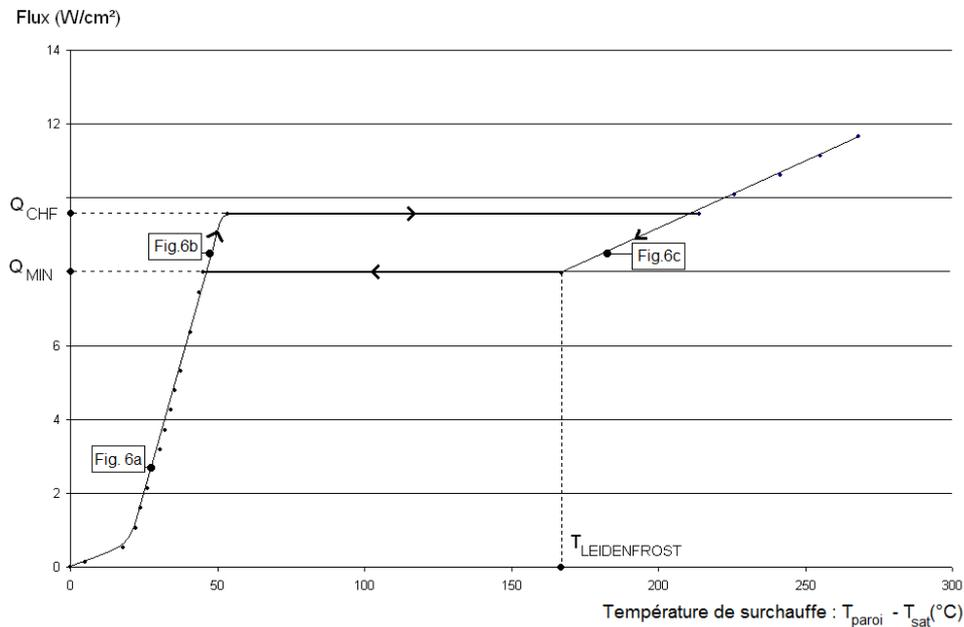
Figure 5 Courbe de Nukiyama pour le HFE7000 ( $T_{sat} = 34^{\circ}\text{C}$ ).
