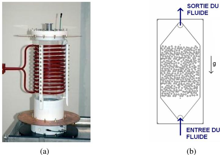
Figure 1 (a) Essais PRELUDE/PEARL, IRSN : Billes d'acier chauffées par induction ;
