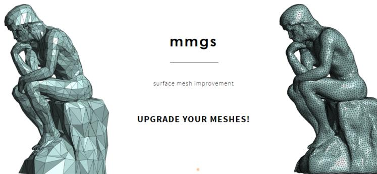
FIGURE 2.7 – Exemple d'adaptation de maillage avec mmgs
