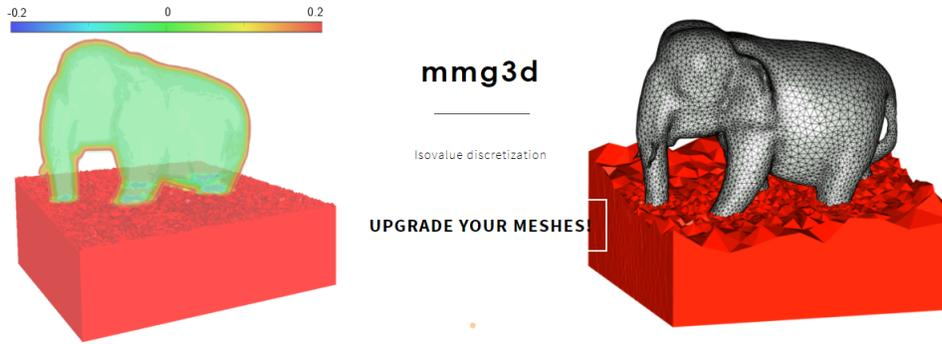
FIGURE 2.8 – Exemple d’adaptation de maillage avec mmg3d
