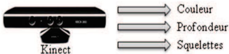
Figure 2 : Eléments de sortie de la Kinect
