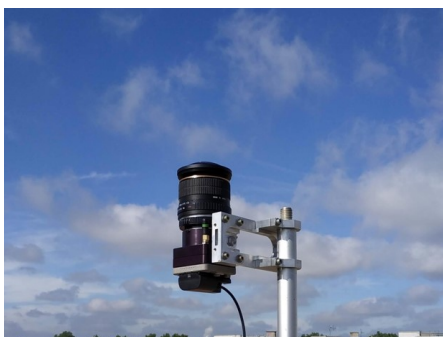
FIGURE 2 – Une photo de CamLight pendant la mesure de luminance du ciel.
