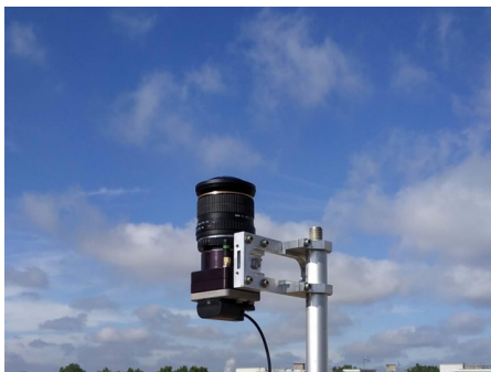
FIGURE 2 – Une photo de CamLight pendant la mesure de luminance du ciel.
