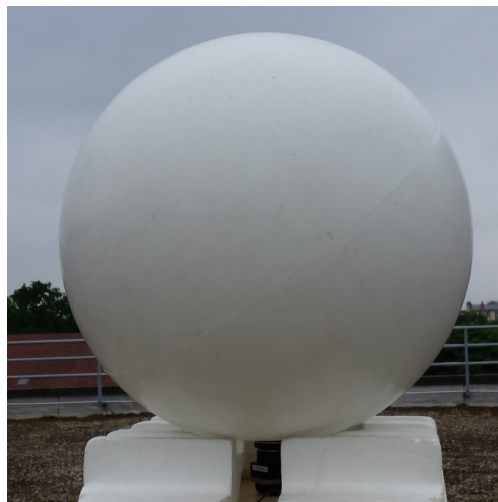
FIGURE 28 – Mesure de champ plat à l'aide d'un ballon diffuseur à l'extérieur par temps très nuageux.
