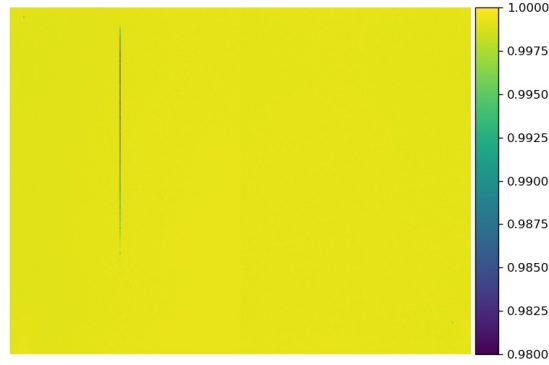
FIGURE 27 – Carte R^2 basée sur les mesures de sphère intégrante pour évaluer la linéarité radiométrique de tous les pixels.
