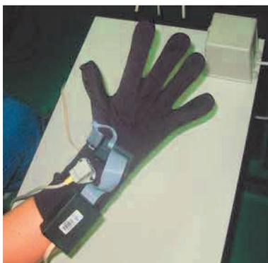
**Figura 3. Data Glove 5DT e captor de movimento Flocks of Birds (Ascension Technology). O captor é preso a *data glove* na altura do punho, ao passo que o emissor de campo magnético encontra-se sobre a mesa, no canto superior direito.**
