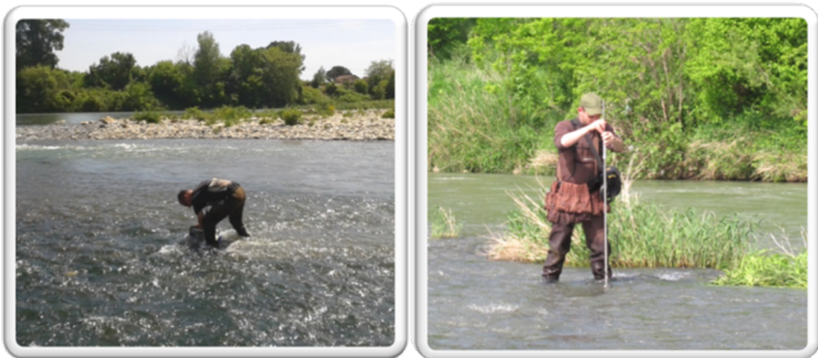
Photo 5.1 , à gauche, échantillonnage au cylindre de Hess (Montélimar, 24/04/2014). Photo 5.2 , à droite, mesure de vitesse moyenne (Montélimar, 27/05/2012).
