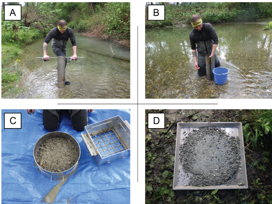
Figure 6.8 - Caractérisation du colmatage interstitiel du lit mineur des bras vifs : A) l'échantillonneur Mc Neil est enfoncé dans le lit du bras, B) puis les matériaux sont extraits jusqu'à la base du tube et C) la fraction > 8 mm est tamisée et pesée sur place et D) la fraction < 8 mm est prélevée pour être séchée, tamisée et pesée en laboratoire.
