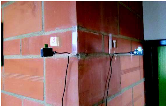
Figure 4. Nœuds DecaWave fixés au mur
