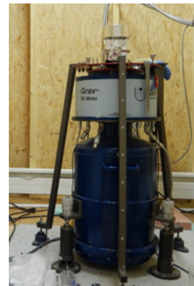
2- Gravimètre supraconducteur iGrav, 2019 Crédits : V. Bertrand - En savoir plus : hal.archives-ouvertes.fr/RESIF/hal-03206882
