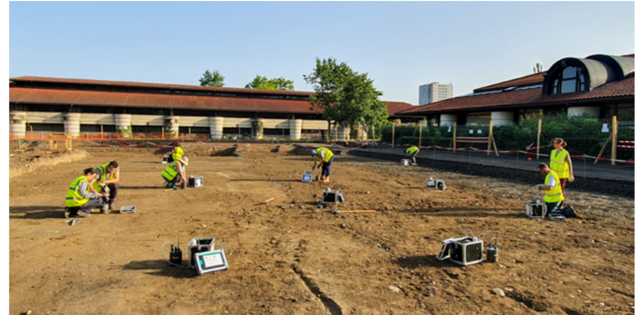
2- Manipe de caractérisation des conditions de sites aux stations RAP. Mise en place des petits réseaux circulaires AVA de rayons 5 et 15 m près de la station PYTB à Tarbes, dans les Pyrénées, le 16 septembre 2019 - Crédits : F. Hollender
