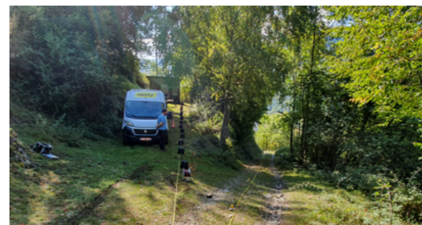
3- Manipes de caractérisation des conditions de sites aux stations RAP. Mesures MASW aux stations PYCA le 20 septembre 2019 (à gauche - crédits : F. Hollender) et CGLR (à droite - Crédits : E. Maufroy). L'acquisition en ligne est déployée à proximité immédiate de la station permanente.
