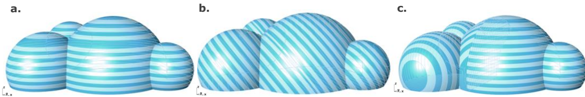
Illustration 7 : Différents exemples de directions de tranchage : a. par plan horizontal (selon l'axe vertical \bar{z} ) ; b. par plan incliné (selon un axe incliné) ; c. par plans de tranchage multiples (un premier niveau de tranchage selon l'axe \bar{x} puis un second niveau selon l'axe \bar{y} d'une part et l'axe \bar{z} d'autre part).
