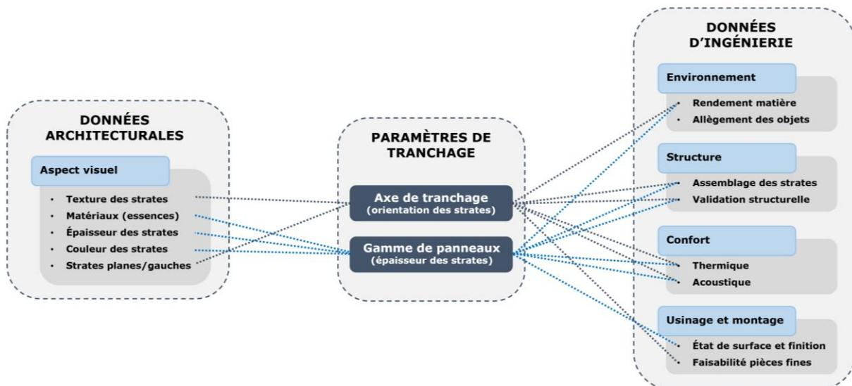
Illustration 6 : Schéma de principe des multiples interactions entre les paramètres de tranchage inhérents à la Stratoconception<sup>®</sup> et les données architecturales et d'ingénierie utilisées en phase de conception.
