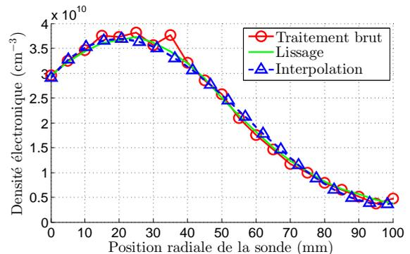
Figure 4. Profil radial de densité électronique mesuré, lissé et interpolé par un polynôme de degré 3 en  $r$ .
