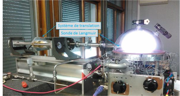
Figure 3. Prototype expérimental avec la sonde de Langmuir montée sur le translateur linéaire.
