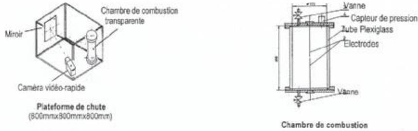
Fig.2 Montage expérimental d'étude de l'extinction des flammes de propane-air
