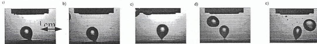
FIG. 1. Bulle d'air injectée au moment du détachement soumise à un champ électrique initialement uniforme en microgravité : a)  $E=0\text{V/cm}$ ,  $V_d=177\text{mm}^3$ ; b)  $E=2.5\text{kV/cm}$ ,  $V_d=167\text{mm}^3$ ; c)  $E=5\text{kV/cm}$ ,  $V_d=143\text{mm}^3$ ; d)  $E=7.5\text{kV/cm}$ ,  $V_d=100\text{mm}^3$ ; e)  $E=10\text{kV/cm}$ ,  $V_d=87\text{mm}^3$ .
