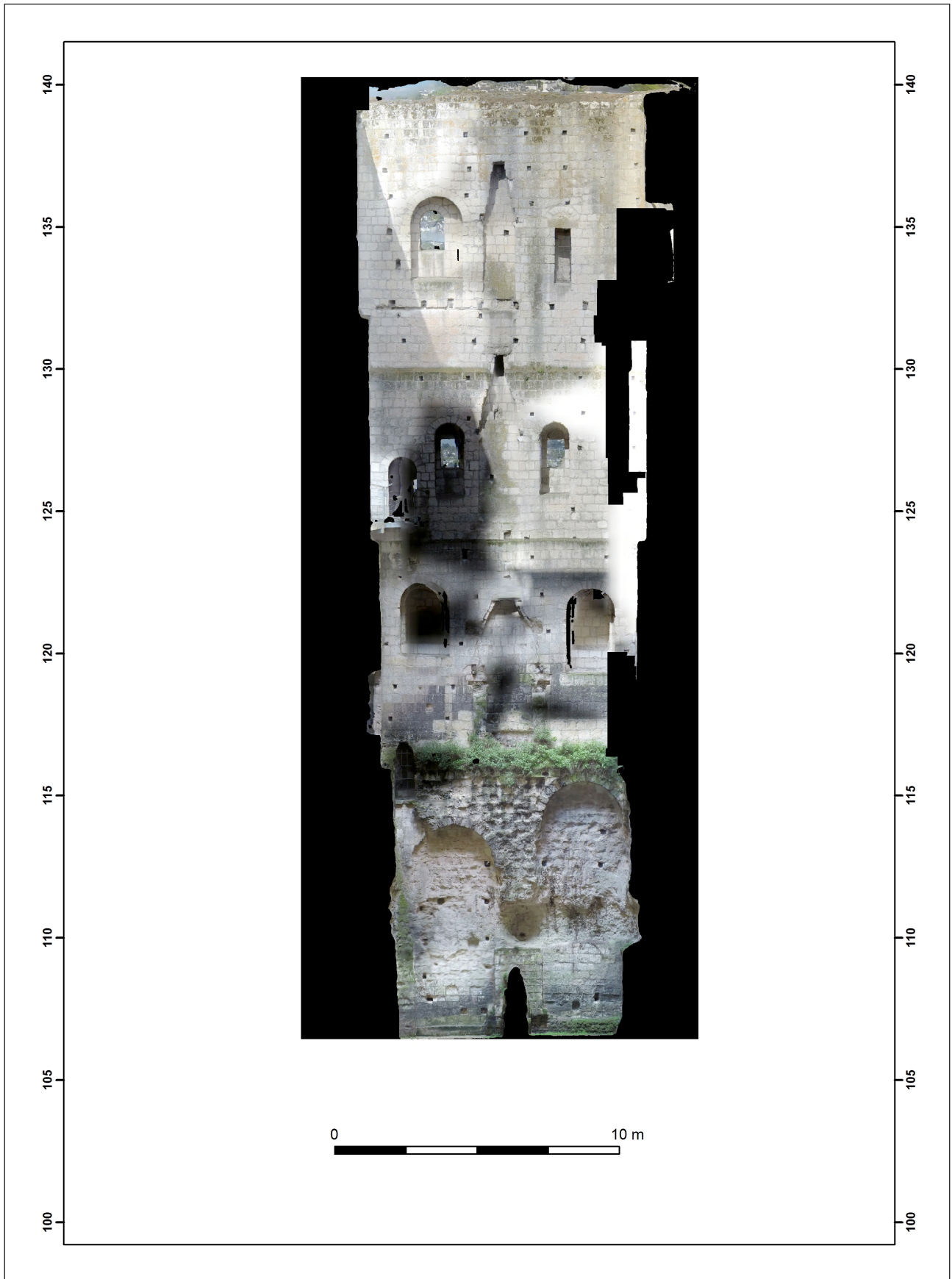
Figure 24 : photogrammétrie de la face interne ouest de la grande tour (Pellerin 2017)
