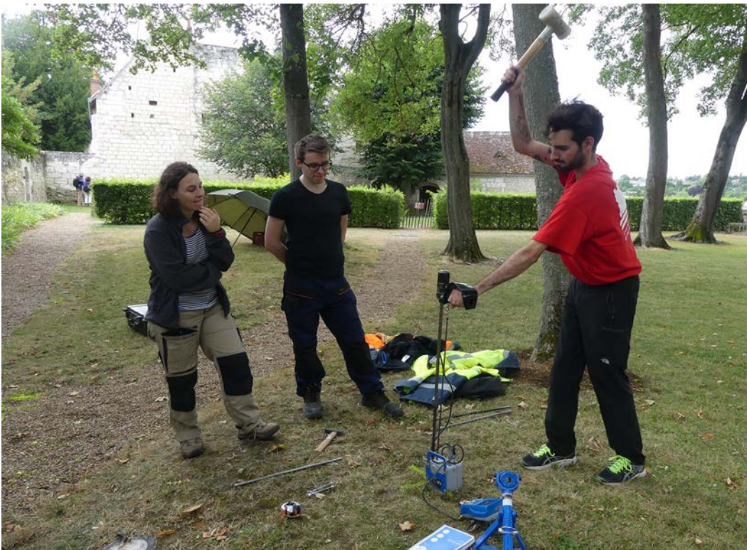
Figure 15 : Sondages géotechniques au PANDA ® en cours de réalisation dans le parc des logis royaux
