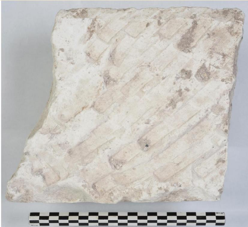
Fig. 34 : Face de joint de lit grossièrement taillée au ciseau du lot 626 (M. Beigneux, CD37).
