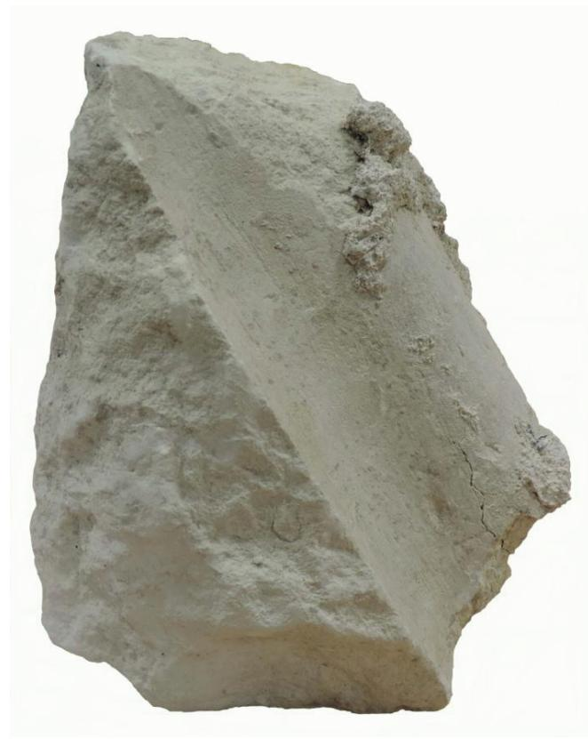
Fig. 62 : Probable face de parement du lot 622, comprise entre l'angle droit formé par deux faces de joints et les moulures obliques en ébrasement (M. Beigneux, CD37).
