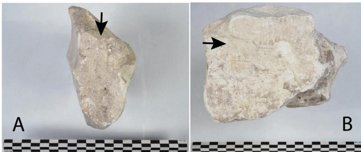
Fig. 35 : Faces de joint de lit finies à la gradine et creusées d'un canal central au ciseau des lots 617 (A) et 622 (B) (M. Beigneux, CD37).
