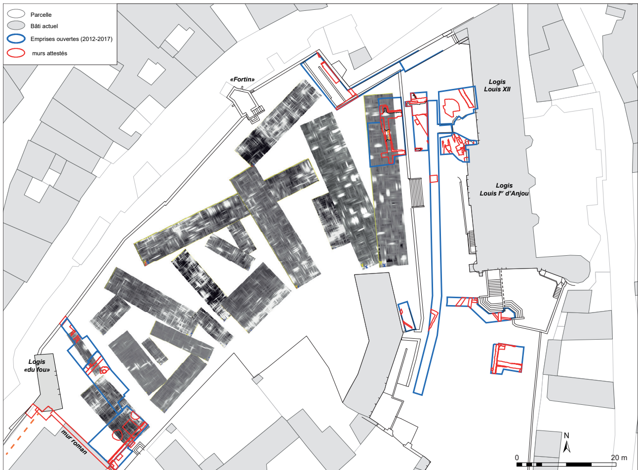
Figure 13 : Cartographie des anomalies radar (prof. 40 à 60 cm)
