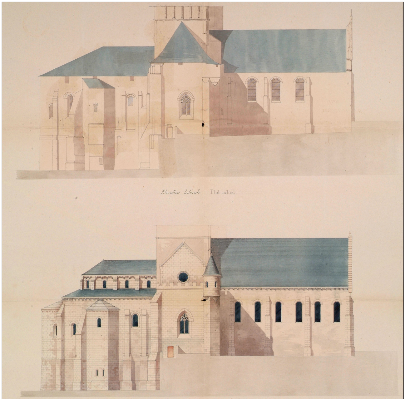
Figure 15 : Projet de restauration de l'église de 1874 – AD37 20105_002 – Détail, élévation longitudinale de la collégiale, état actuel/état projeté
