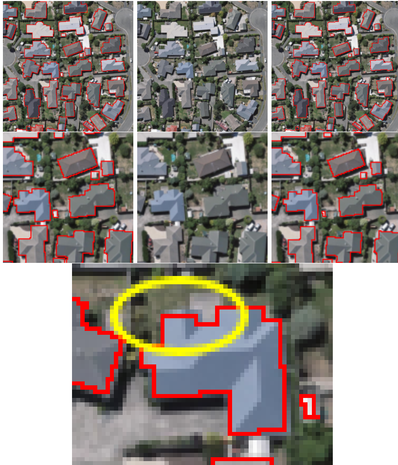
FIGURE 3.1 – Illustration de l’ambiguïté du placement des bords des objets en segmentation sémantique même dans le cas d’une vérité terrain de très bonne qualité faite à la main (ici sur la base de données AIRS [49] rééchantillonnée à 50cm). À gauche, les bords externes (la ligne rouge est supposée être au bord mais en dehors des bâtiments), à droite les bords internes (la ligne rouge est supposée être le bord des bâtiments). Il est très difficile de faire la différence à l’œil sans zoomer comme dans l’image de la 3ème ligne où on voit que le placement du bord est discutable. Ce problème n’est pourtant pas cosmétique car on perd 10% d’IoU en prédisant la ligne rouge de gauche au lieu de celle de droite.
