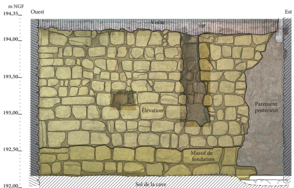
Figure 5 : Figure 5 : Ortho-image du parement sud et relevé au 1/20e (M. Panneau)
