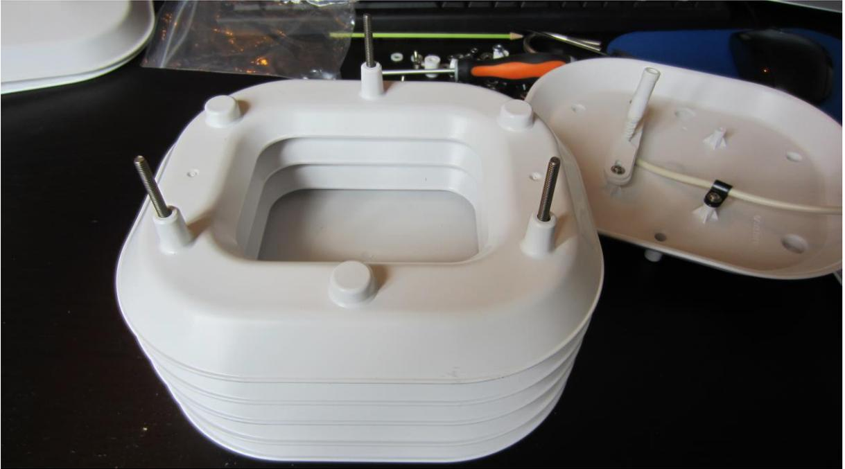
Etape n°4 : Insérer la capsule avec la sonde en dernier. La sonde doit se retrouver dans l'espace creux créé par les capsules avec un trou central.
