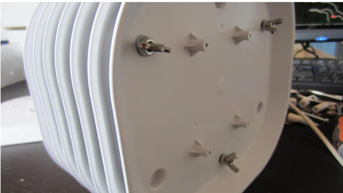
Etape n° 8 : Insérer la capsule couvercle sur le dessous puis insérer dans l'ordre : 1 tube blanc, 1 rondelle plate, 1 petite rondelle, 1 boulon et serrer l'ensemble
