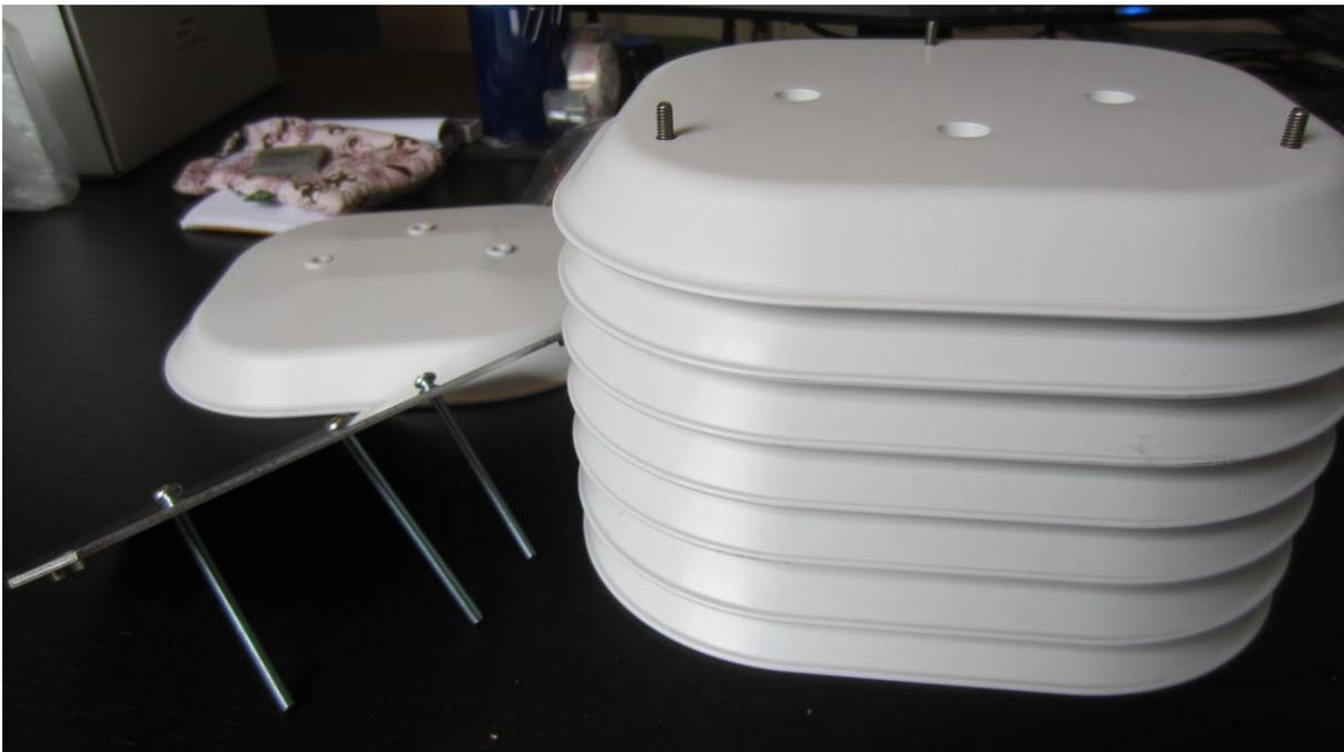
Etape n°6 : Disposer la plaque métallique avec les grandes vis en ayant au préalable insérer 3 vis
