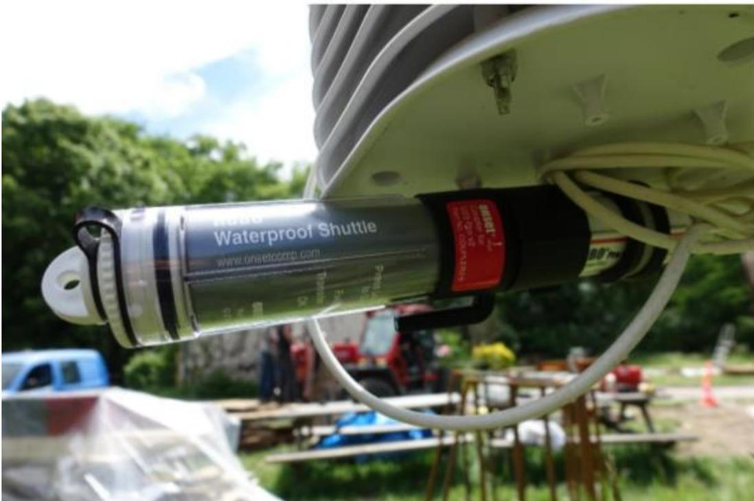
Fig. 95. Navette de transport connectée à l'enregistreur de la station Hobo®.
