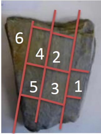
Prélèvement de la discontinuité ouverte Sampling of the open discontinuity
