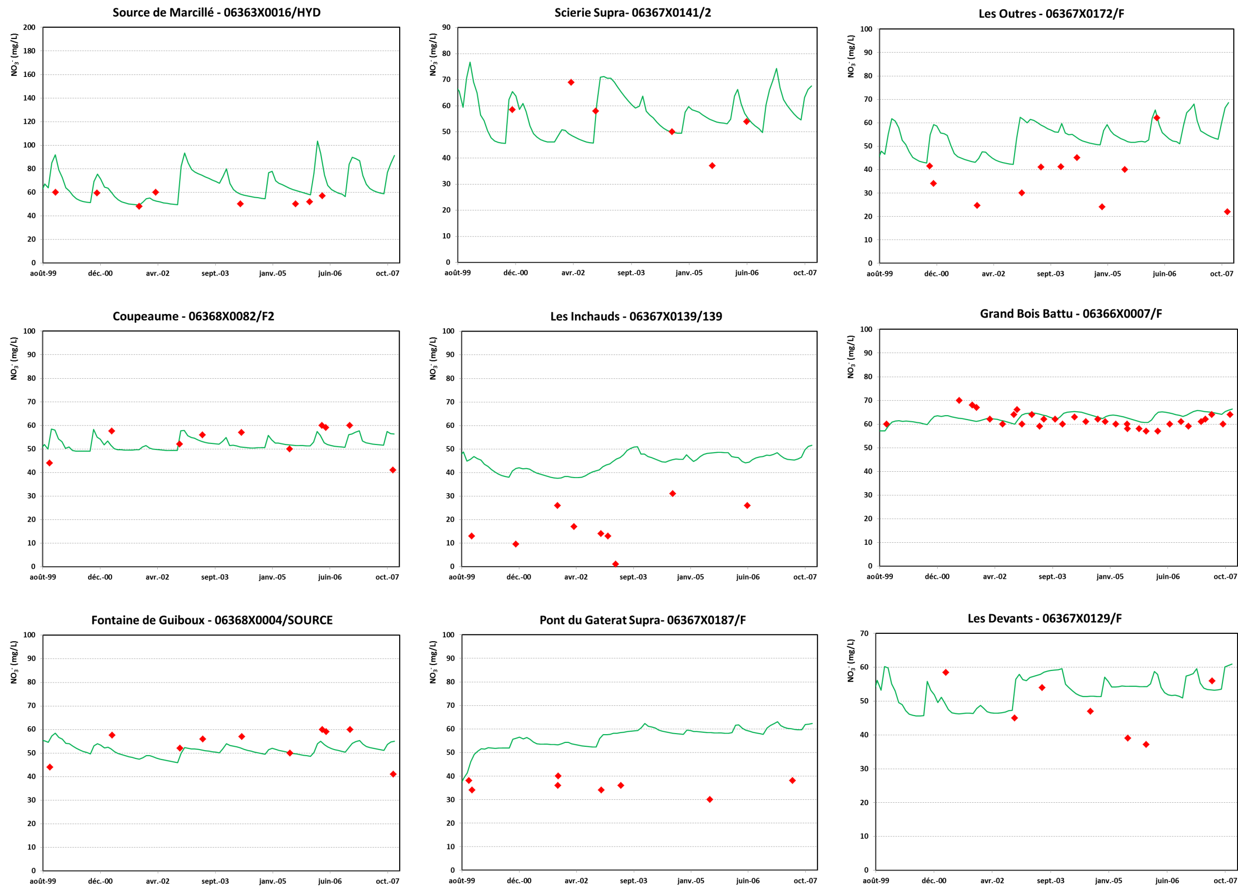
Illustration 50 : Comparaison des chroniques issues du modèle (trait vert) aux analyses de terrain réalisées sur les qualimètres (point rouge) à la nappe du Dogger
