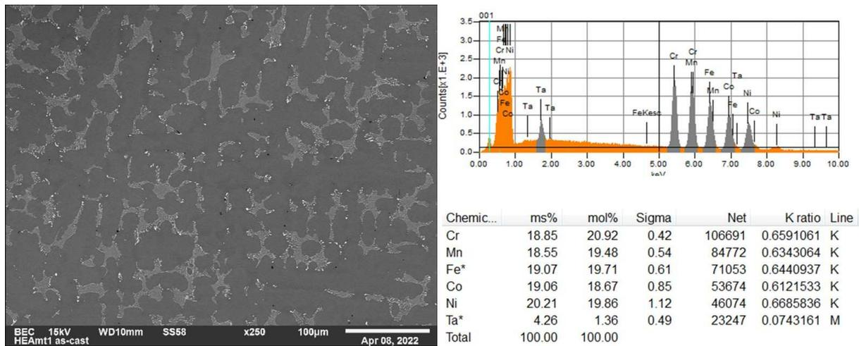
**Figure 8 : Image MEB/BSE de l'alliage CoNiFeMnCr additionné de Ta et de C avec les résultats d'analyse EDS sur toute la plage observée : spectre EDS obtenu et composition chimique générale de l'alliage**
