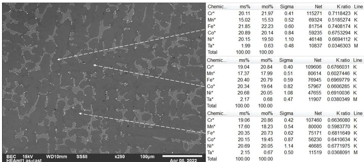
**Figure 9 : Image MEB/BSE de l'alliage CoNiFeMnCr additionné de Ta et de C avec les résultats d'analyse EDS ponctuelle au cœur des dendrites de matrice**
