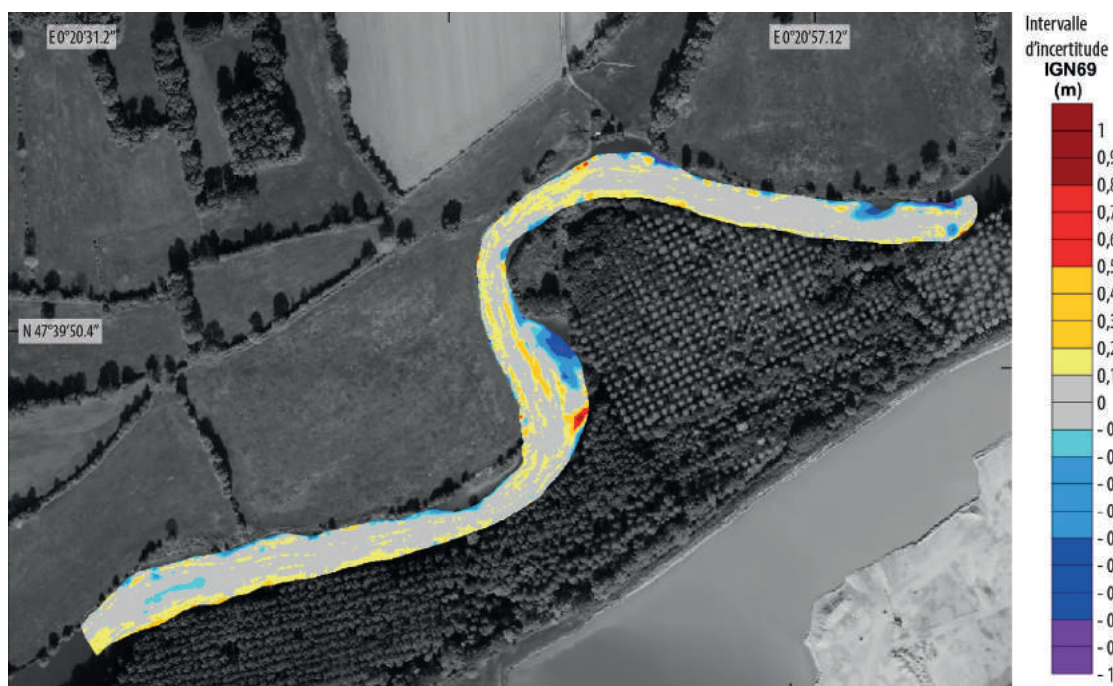
Fig. 17 – Écart d'altitudes du fond du lit entre le 28 janvier et le 20 octobre 2014 (site de Bruant).
