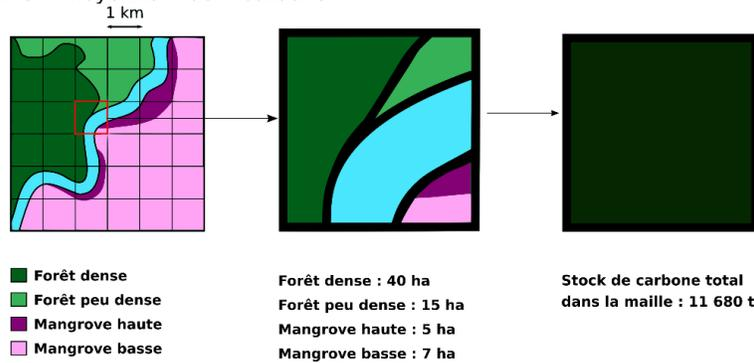
**Figure 3 :** Exemple d'application de la grille pour le calcul des stocks de carbone par unité d'espace
