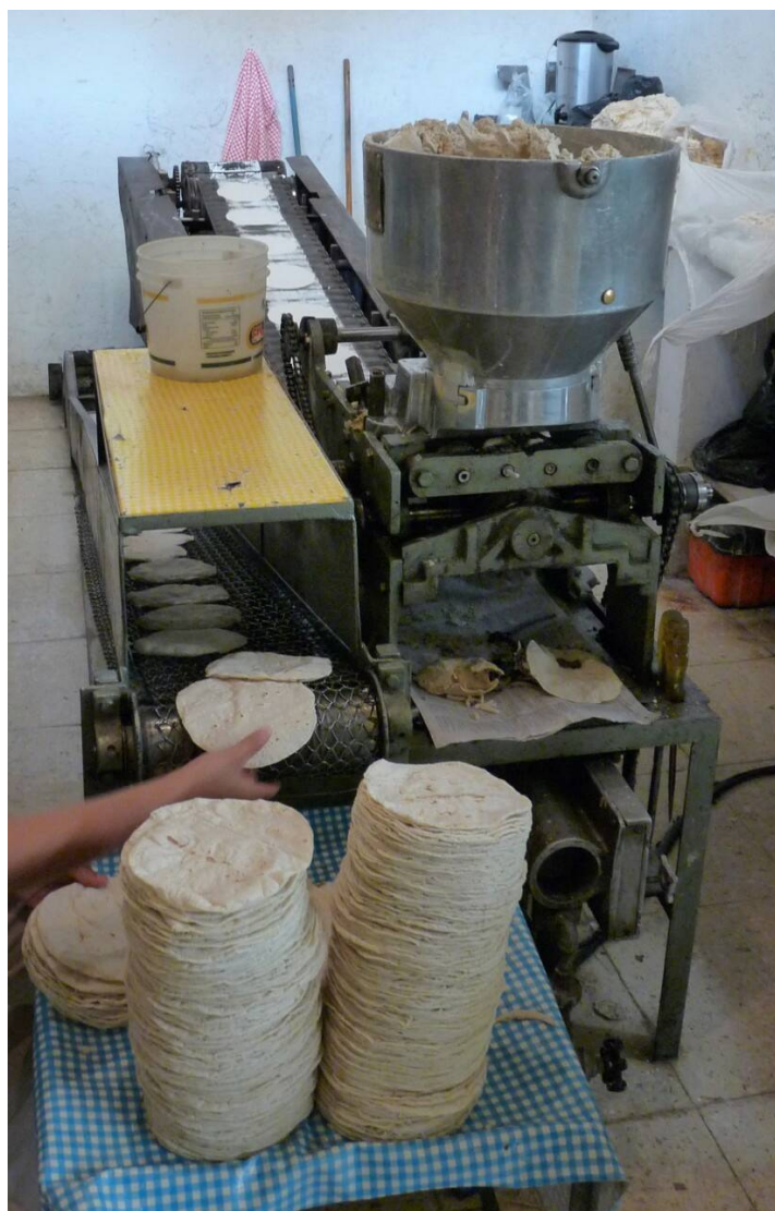
Fig. 2 : Une machine de tortillería de farine de maïs (source : Creative Commons)
