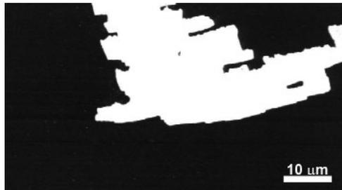
**Figure 10 :** Texture en microscopie optique (polariseurs croisés) d'un smectique C chiral stabilisé par les surfaces (*SSFLC*). Les deux types de domaines apparaissant spontanément correspondent à une polarisation perpendiculaire au plan d'observation pointant soit vers l'observateur soit vers l'arrière.
