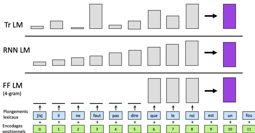
FIGURE 3 – Les encodage du contexte gauche réalisés par divers modèles de langue : les modèles  $n$ -gramme (FF LM) n'encodent qu'un contexte réduit ; les modèles RNN accordent plus d'importance aux mots les plus proches ; les Transformers (Tr LM) apprennent un encodage qui traite à égalité tous les mots du contexte.
