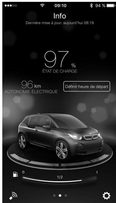
**Photo 1 : Capture d'écran d'une application déportée de gestion de la charge privée : informations fournies en temps réel sur l'état de charge de la batterie et l'autonomie disponible, et sur la programmation de la charge de la BMW i3.**
