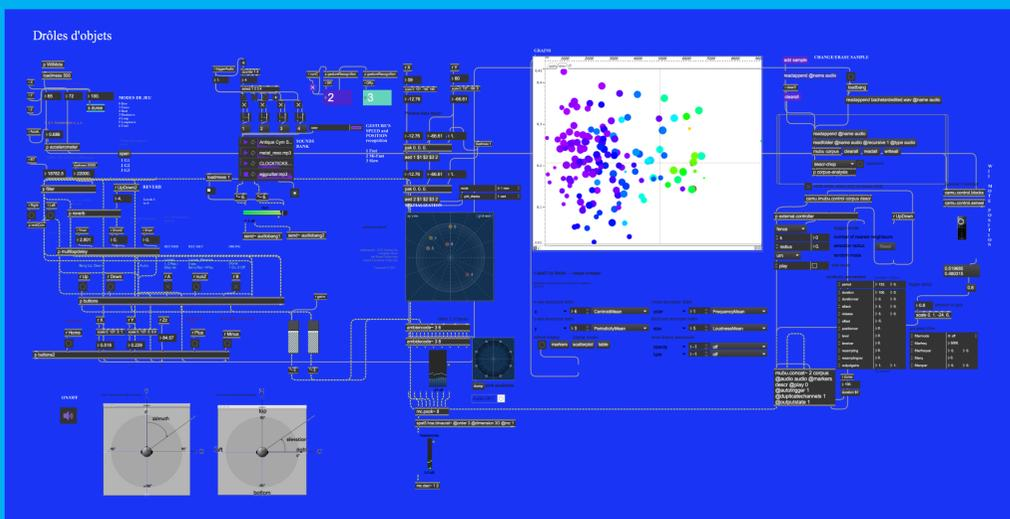
Les données émises par la télécommande Wii, sont transférées par la médiation de "Osculator" à l'environnement Max Msp par OSC, où elles sont mappées et mises en échelles.
