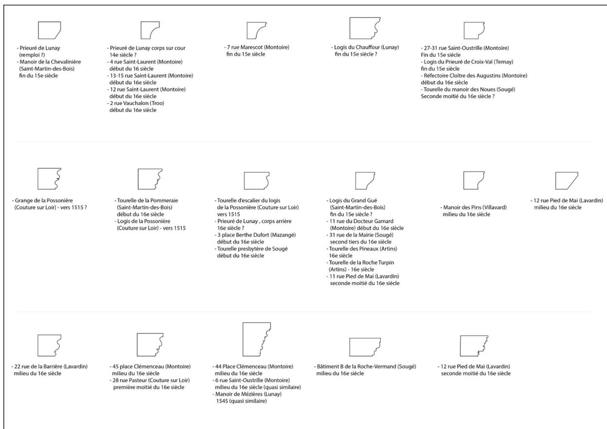
Figure 38 : Schéma des différentes formes de corniches repérées
