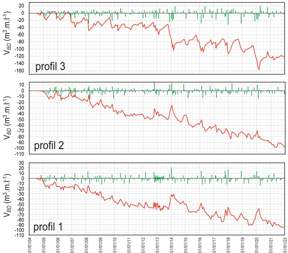
Figure 3 – Bilans sédimentaires du système plage / dune pour les 3 radiales 1, 2, et 3 entre juillet 2004 et décembre 2021 (barres vertes : fréquences séparées ; ligne rouge : fréquences cumulées)
