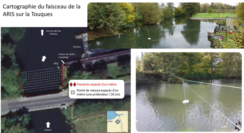
Figure 6 : Illustration du protocole de cartographie du faisceau efficace de la ARIS sur la Touques.
